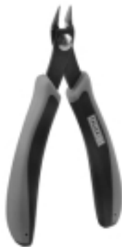
170688 Spezial-Seitenschneider zum gratfreien Abtrennen von feinsten Spritzteilen. Spitze 48° abgewinkelt. Nur für Polystyrol geeignet.
